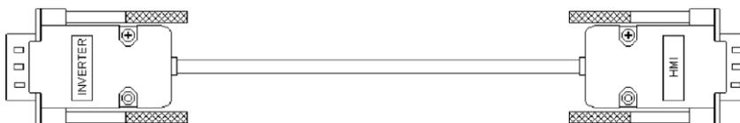
Figura 8.10 - Cabo para uso remoto da HMI
